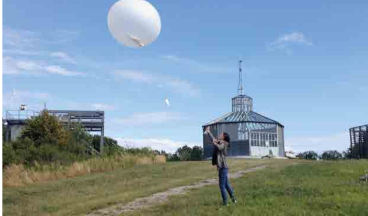
Professorin Dr. Stephanie Fielder lässt beim Deutschen Wetterdienst in Lindenberg bei Berlin eine Radiosonde aufsteigen. Solche Sonden übermitteln Messwerte wie Lufttemperatur und Luftfeuchtigkeit an die Bodenstation
