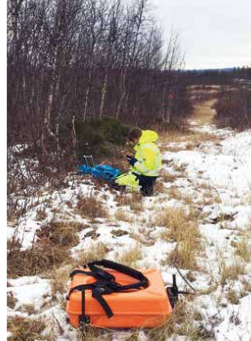
Ein Stromsignal, das in den Boden geleitet wird, gibt Aufschluss darüber, wie der Untergrund beschaffen ist.
