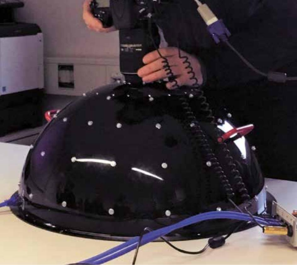
Der »Kölner Dome«, eine Konstruktion des Cologne Center for eHumanities. Der Apparat erlaubt es, Siegel und andere Objekte aus verschiedenen Winkeln anzuleuchten und zu fotografieren. So werden besonders schwer lesbare Inschriften wieder sichtbar
