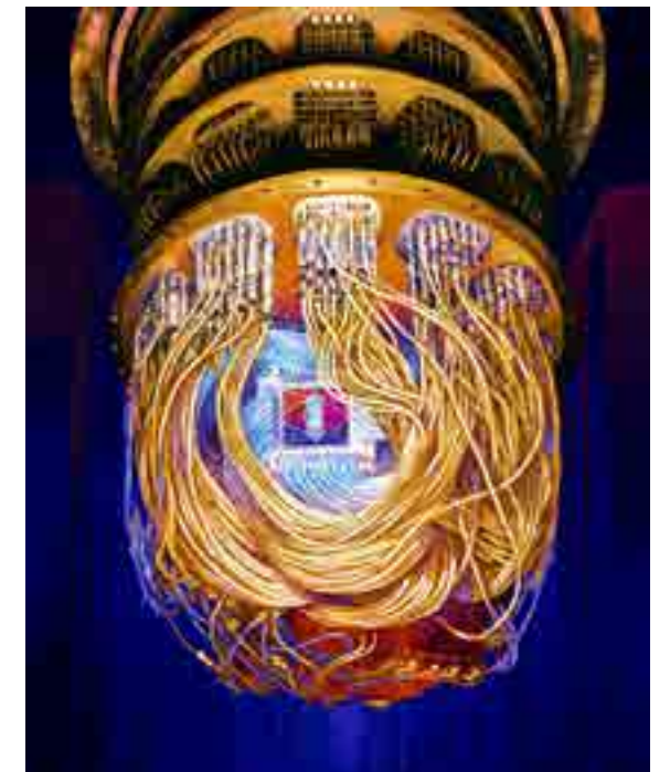
Der Kryostat hält die Temperatur der Quantenchips konstant kühl, denn sie sind anfällig für kleinste Umweltveränderungen.
